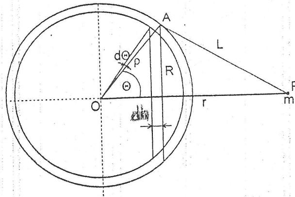
приповерхневий шар радіусом  $\rho$ . Маса цього шару -  $dM$ . Товщина шару з нескінченно тонкою стінкою -  $d\rho$ .
