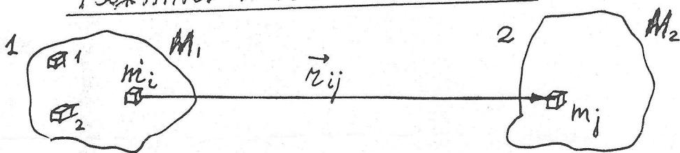
$$\vec{f}_{ij} = -\gamma \frac{m_i m_j}{r_{ij}^2} \vec{r}_{ij} \quad (1)$$
